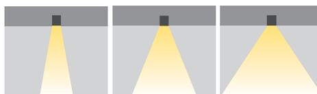
N: Узкий угол M: Средний угол W: Широкий угол
