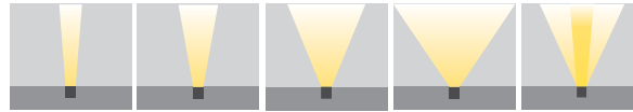
XN: Ekstra Dar Açılı N: Dar Açılı M: Orta Açılı W: Geniş Açılı E: Eliptik Açılı
